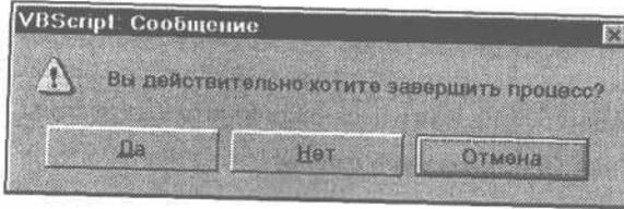
Рис. 9.15. Диалоговое окно, отображаемое функцией MsgBox
