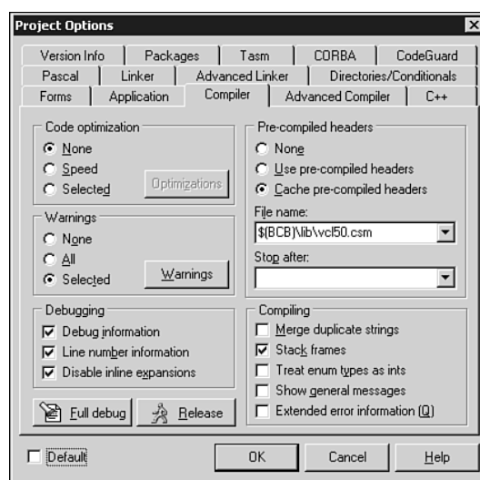
Рис. 2.11. Диалоговое окно Project Options с глобальными параметрами приложения Doodle с отключенной оптимизацией кода
