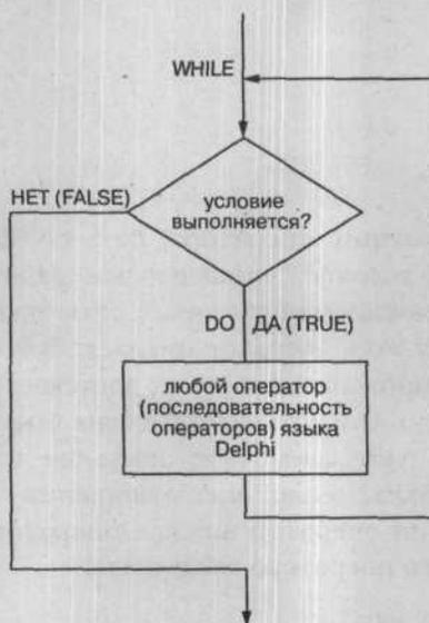
Рис. 3.6 ▼ Блок-схема работы оператора `while-do`
