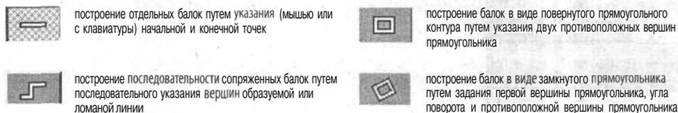
Рис. 6-45. Варианты построения балки
