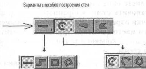
Рис. 6-6. Информационная панель проектирования стен и способы построения стен
