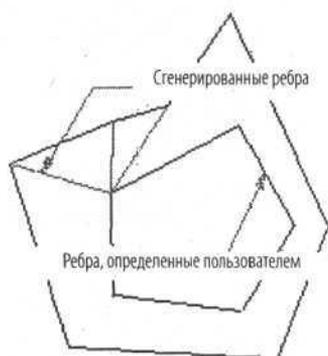
Рис. 6-99. Процесс построения сетки
