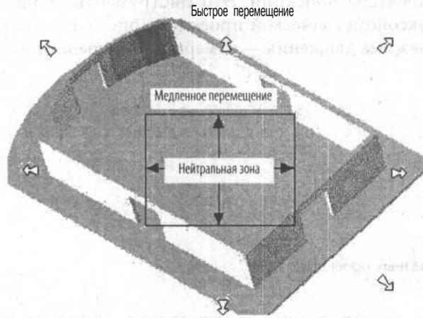
Рис. 5-17. Основа трехмерной навигации по графическим образам
