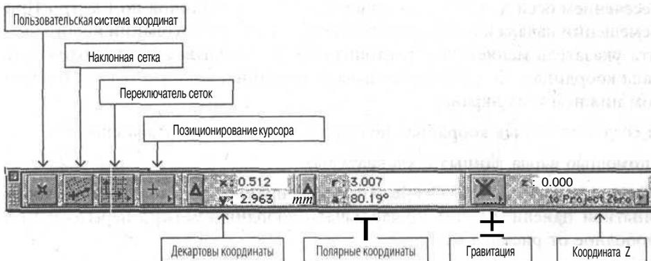
Рис. 3-3. Координатная панель
