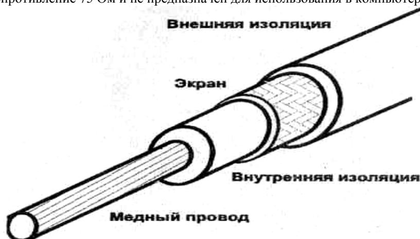
Рис. Коаксиальный кабель (схема).
